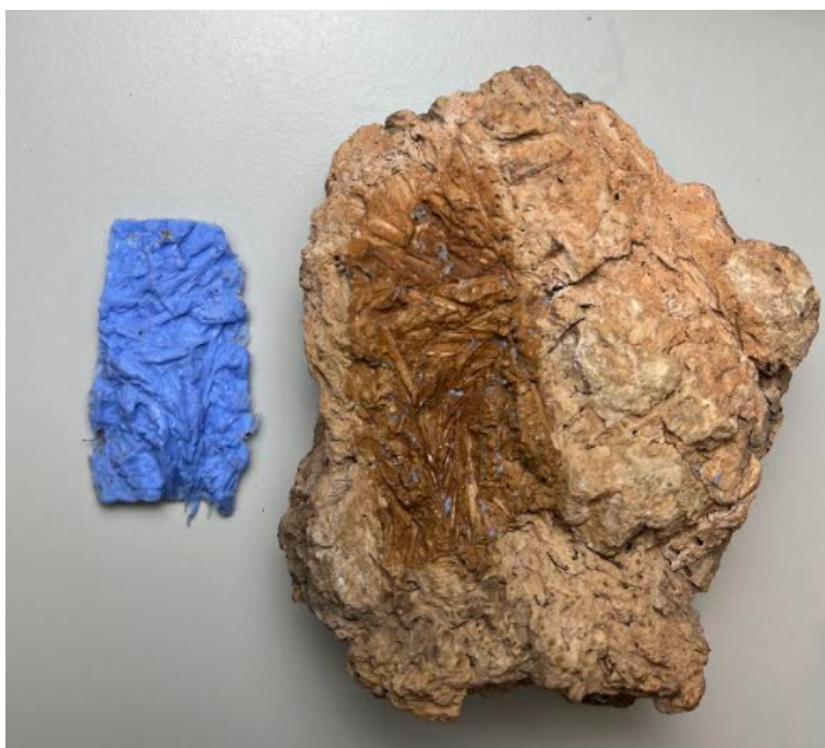
Pav. 5. Sustingusios silikono išliejos pašalinimas.
