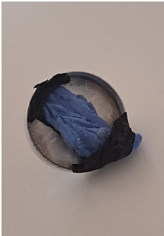
Pav. 6. Skenavimui paruošta silikono išlieja.
